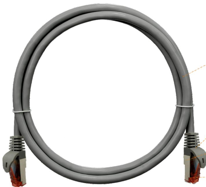
Экранированный (S/FTP) патч-кабель из 4-х витых пар многожильных медных проводников (7x0,150мм) в оболочке из LSZH - компаунда
